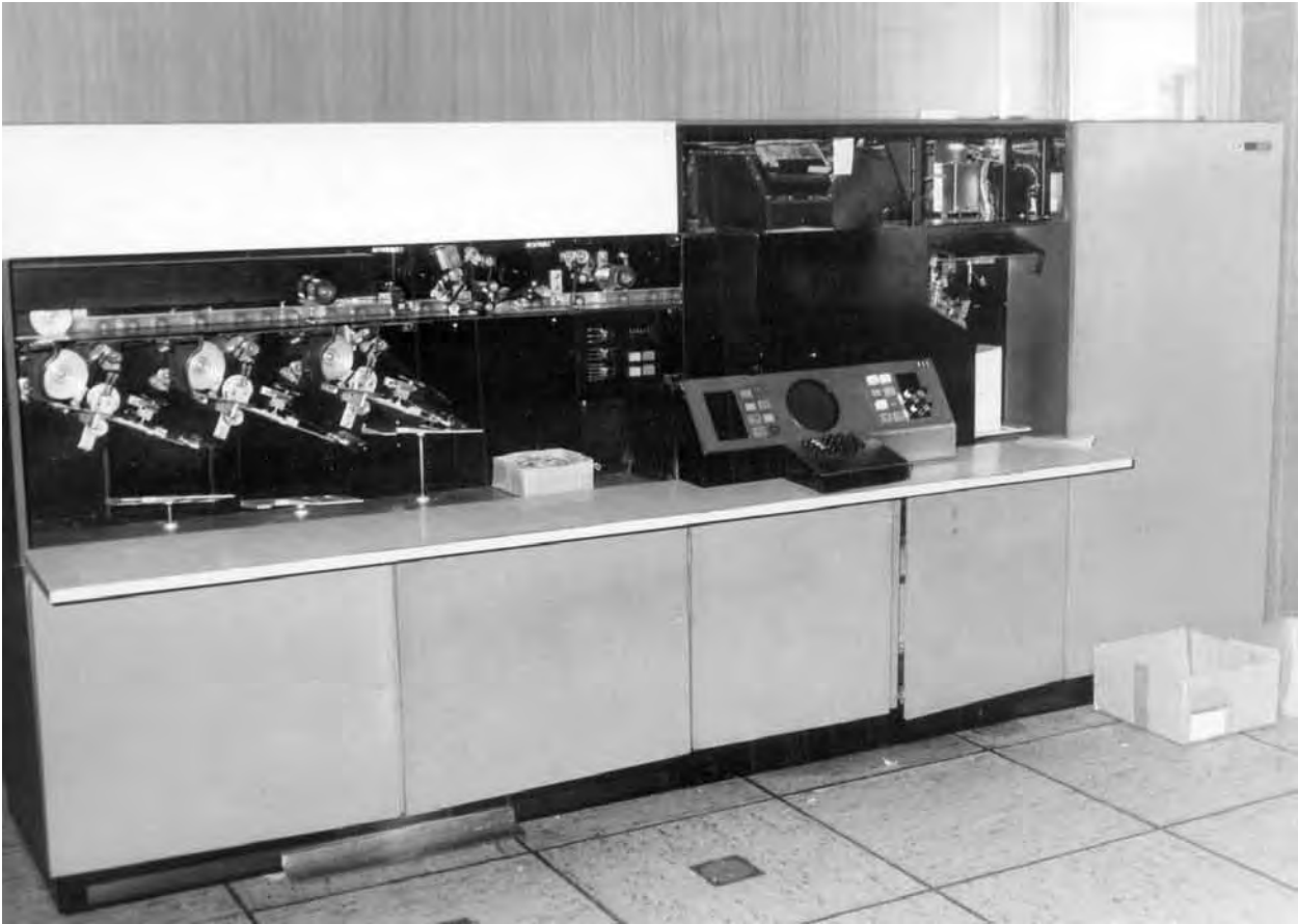
Čitalnik receptnih obrazcev je bral dokumente (polja, izpolnjena s pisavo OCR) in jih odlagal v tri predale.
